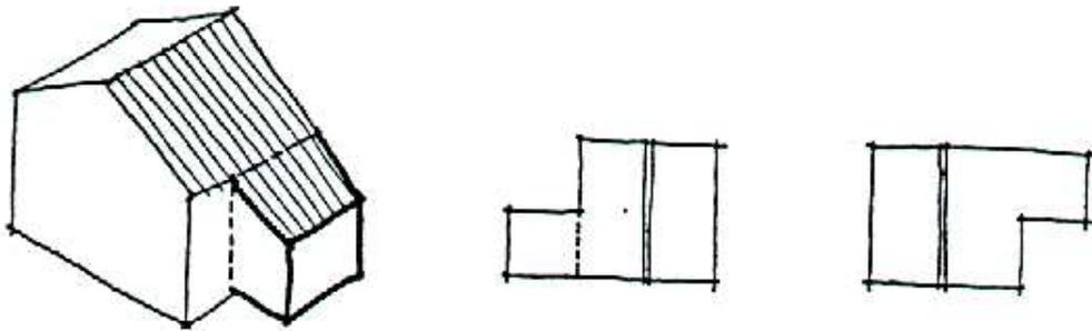
b - EDIFICIO A PIANO UNICO CON TETTO A QUATTRO O PIU' FALDE
