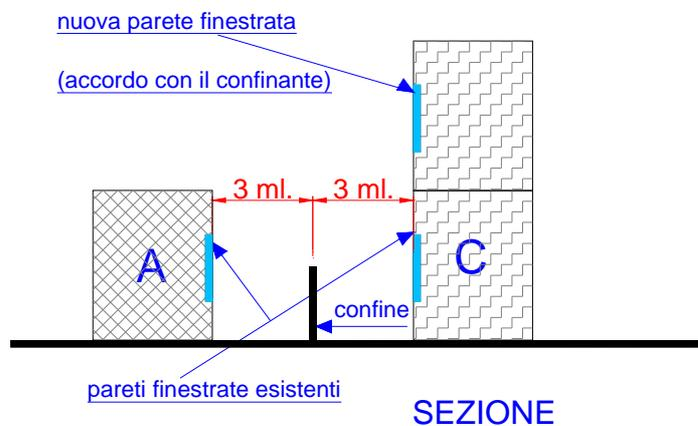
CASO 11°) Edifici esistenti A e C con pareti finestrate a distanza inferiore a 10 ml. Posso ampliare C planimetricamente a distanza inferiore a 5 ml. dal confine con una nuova parete non finestrata.
