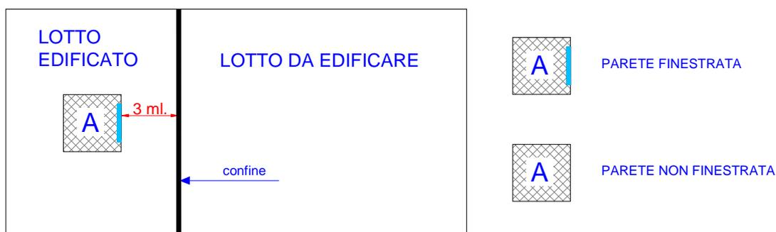
Il nuovo edificio (B) dovrà distare 10 ml dalle pareti finestrate di quello esistente (A) che è posto a meno di 5 ml dal confine, effettuando la reciproca proiezione delle pareti finestrate.
