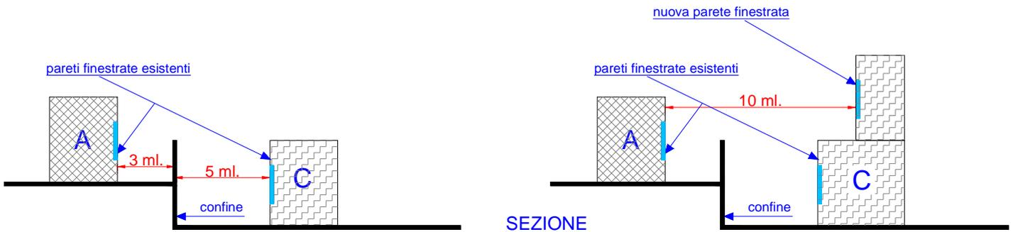
CASO 10°) Edifici esistenti A e C con pareti al piano terra finestrate a distanza minore di 10 ml. Posso sopraelevare C con parete finestrata a condizione che si ottenga accordo con il confinante mediante atto trascritto per una diversa ripartizione del parametro inderogabile  $D_{pf}$  (nel caso di parete non finestrata non necessita atto di accordo).
